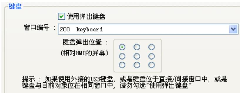
在选择“200. Keyboard”后,当用户触控“数值输入”或“字元输入”元件时,EB8000画面中将自动弹出“窗口200”,触控“窗口200”上的“功能键”元件将等同键盘输入信号,如下图所示。
