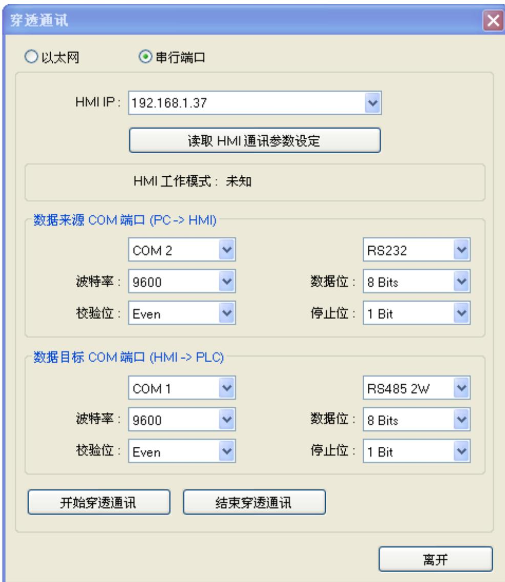
点击[开始穿透通讯], 触摸屏将切换至穿透通讯模式, 用户可以执行在线监控, 这时PC应用程序可以通过触摸屏控制PLC, 而触摸屏此时可以被视为转换器。
