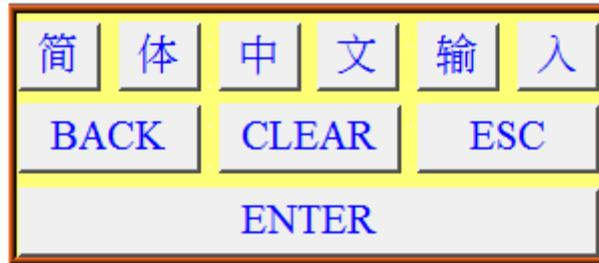
此时窗口上的元件皆为功能键元件，并依实际用途选择适当的属性。以输入“简”这个文字的功能键为例，需选择[ASCII]/[UNICODE]方式，并将输入内容设定为“简”，参考下图：
