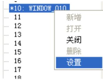
第二种方式是在各窗口中,在未选择到任何元件时触控鼠标的右键,选择[属性]即可出现设定对话框,此时也可更改窗口的属性。
