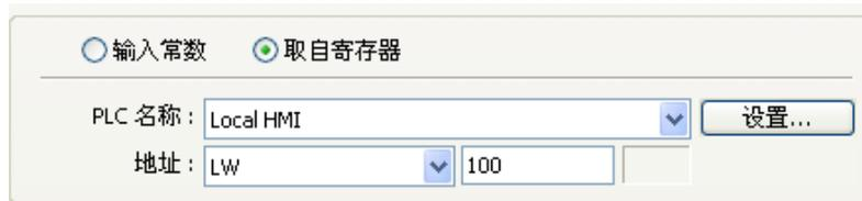
选择输入数值的上、下限来自指定的寄存器。此时寄存器的资料长度与元件所显示的数据类型有关。举例来说,上图的输入上、下限来自[LW100],此时输入上下限的存放地址如下:
