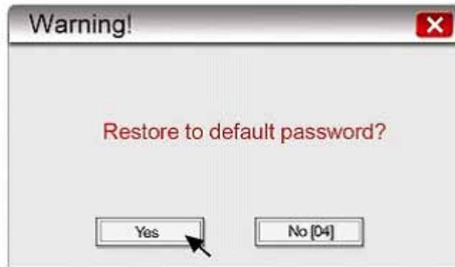
当选择为YES后, 会弹出另一个对话框, 如下图。此对话框将再次确认用户是否要将MT8000的系统设定密码恢复为出厂设定, 并且要求用户输入YES做为确认, 在完成输入后触控OK即可。(MT8000系列出厂时的系统预设密码为111111, 但必须重设其它密码, 包括download与upload所使用的密码皆需重设。)
