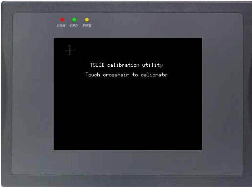
在这个模式下, 当MT8000系列触摸屏电源开启时, 就会在屏幕的左上角出现一个“+”, 使用触控笔或手指触控这个“+”的中间, 它就会移动。它会出现在左上角、右上角、右下角、左下角以及屏幕中央位置, 当这五个点都被准确触控之后“+”会自动消失。同时校准参数会保留在触摸屏的系统里面。
