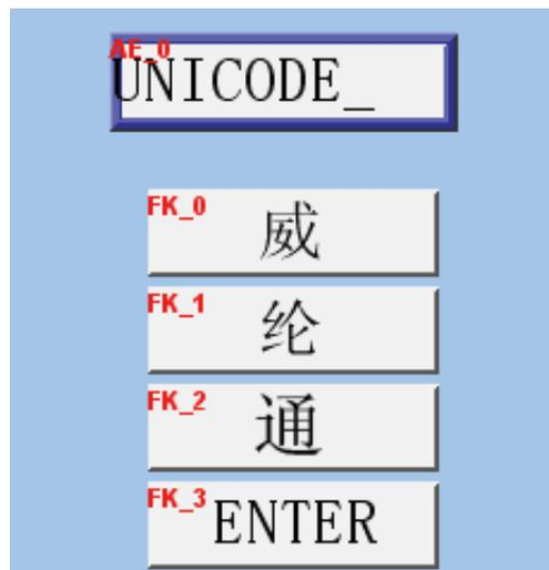
小结: 数字键盘和字符键盘均是使用“功能键”元件制作, 并结合在一起形成的。用户可以将自制的键盘群组为“群组图片”添加到“群组图库”中, 以便于后续的调用。如果不使用系统预设的键盘, 也可以将自制的键盘, 添加到: 系统参数-一般属性- 键盘中, 作为新增的系统键盘。
