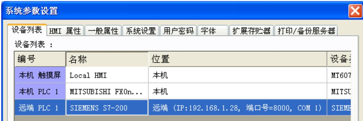
此时在所有元件的[PLC 名称]选项中, 将可发现这些已完成设定的设备, 选择指定的设备即可操作这些PLC。
