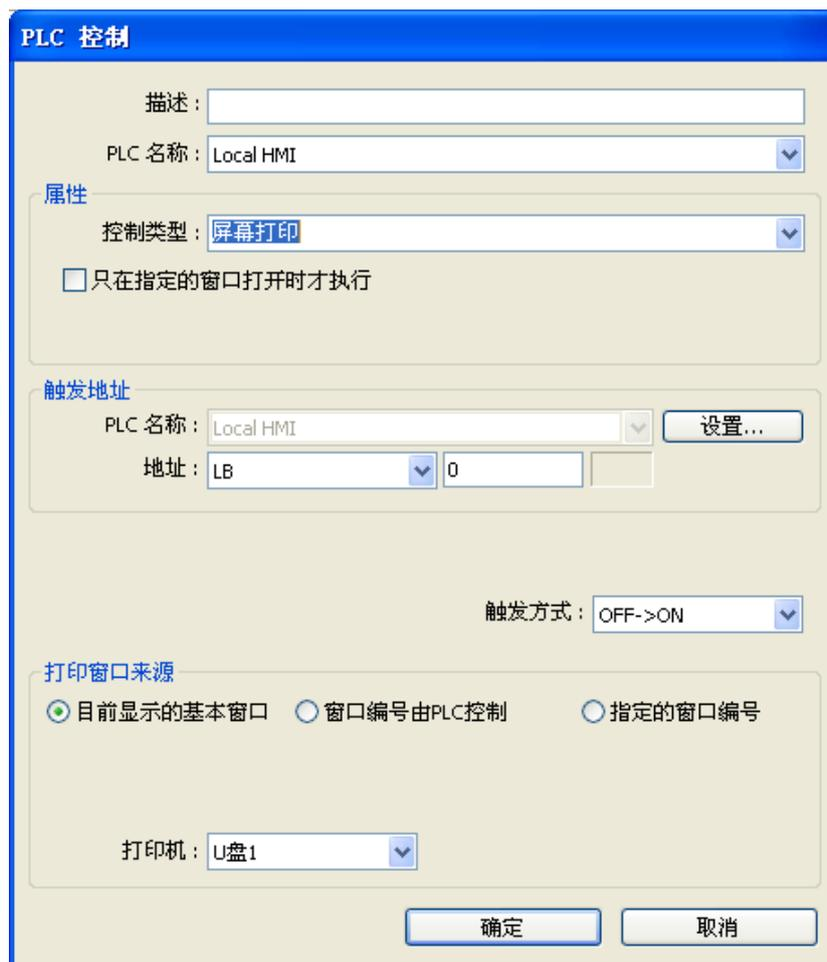
目前显示的基本窗口：“PLC控制”元件将打印目前显示的画面
