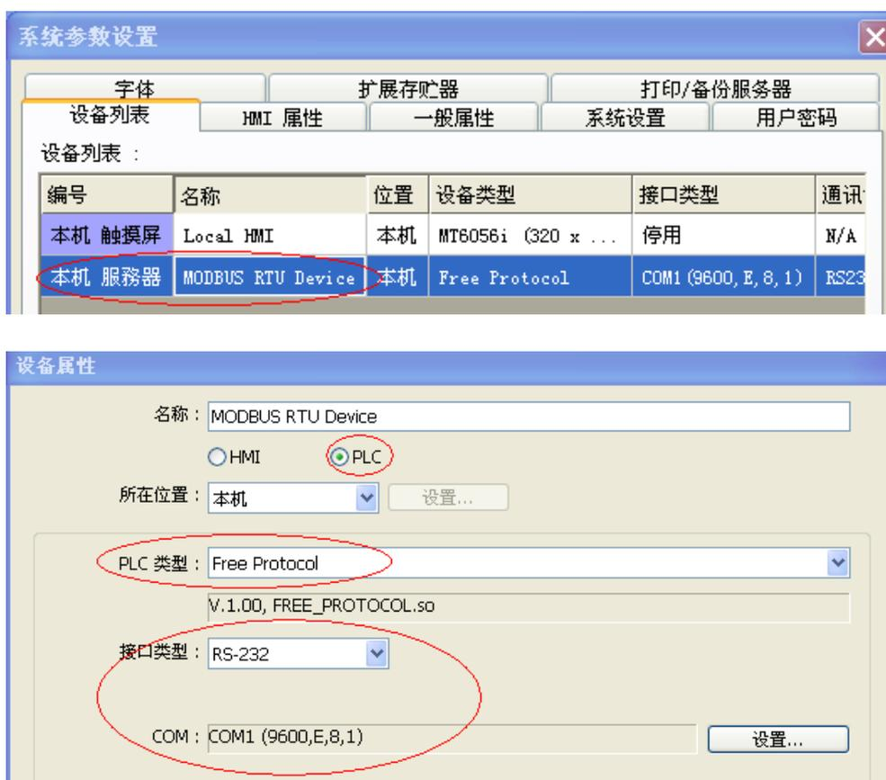
这里的设备连接使用RS232,如果连接一个MODBUS TCP/IP设备,这个界面接口类型必须设定为“以太网口”,同时必须设定正确的IP地址和端口号,如下图所示:
