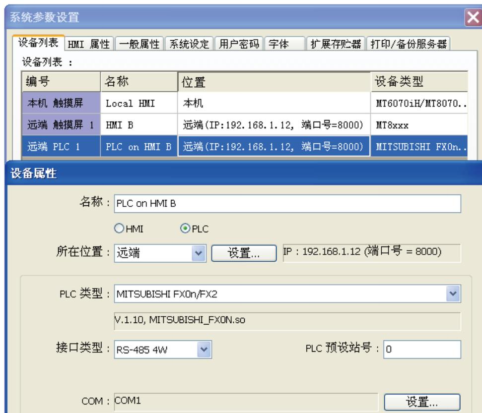
由上图可以发现，此时新增的PLC的所在位置为“远端”，因为该台远端PLC是连接在HMI B上，所以设定的IP为HMI B的IP (192.168.1.12)。
