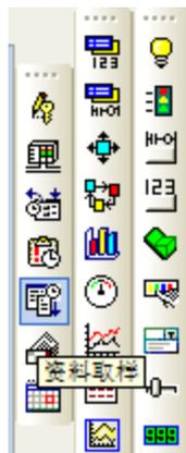
使用“趋势图”元件及“历史数据显示”元件可以检视资料取样记录的内容,但首先必须定义资料取样的方式,触控工具条上的工作按钮后会出现“资料取样管理对话框”,参考下图。
