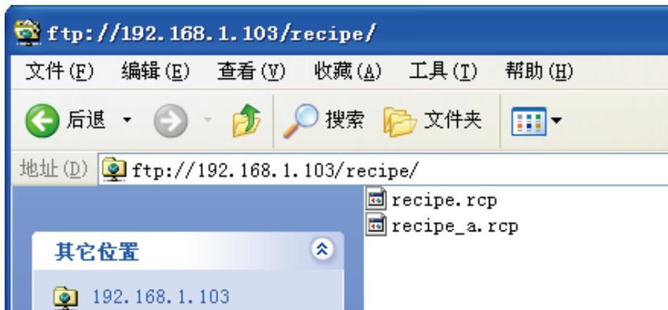
注意事项:若是更新recipe.rcp后,务必于1分钟内重开机或是使用LB-9048 LB-9047将HMI重开机。需先将LB-9048设ON后再将LB-9047设ON以顺利完成重开机的动作。
