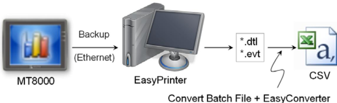
如上图所示, 此转换功能实际由EasyConverter执行, EasyPrinter至少遵照转换批次档的标准用正确的参数启动EasyConverter达成转档指示。
