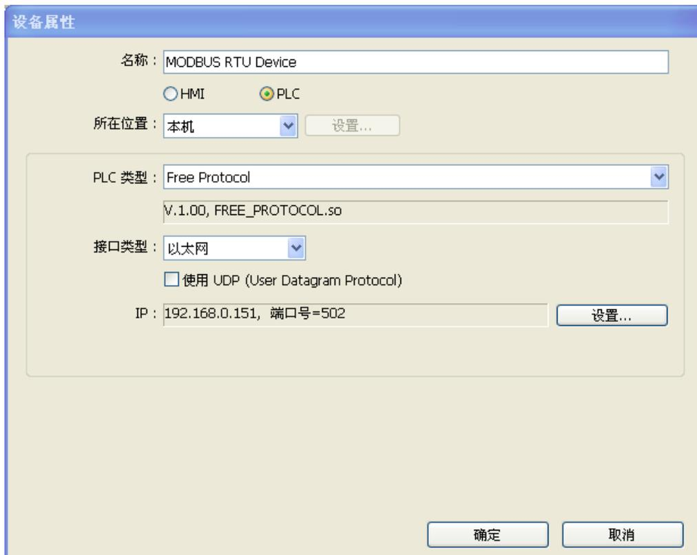
假如MT8000触摸屏将要读取设备中的4X\_1和4X\_2两个数据寄存器。首先，使用OUTPORT函数发送读取命令给这个设备，OUTPORT函数的写法为：
