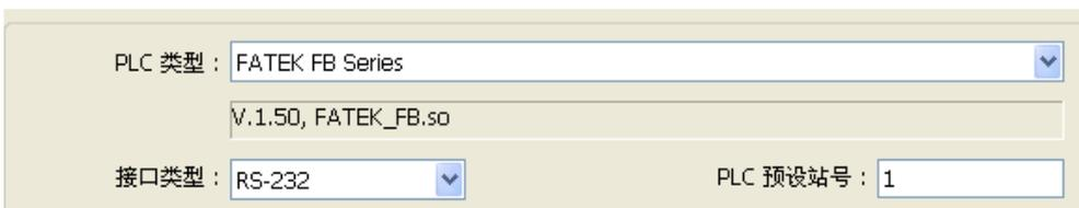
步骤2: 设定正确的通讯参数, 此时HMI 2的COM 1是与HMI 1的COM 2相互连接, 并不是与PLC直接连接, 因此必须忽略PLC的通讯参数, 而应让HMI 2的COM1与HMI 1的COM 2所使用的通讯参数相同, 因此HMI 1的COM 2使用RS232通讯, 通讯参数为[115200、E、8、1], 所以HMI 2的COM1也需依此参数设定, 参考下图:
