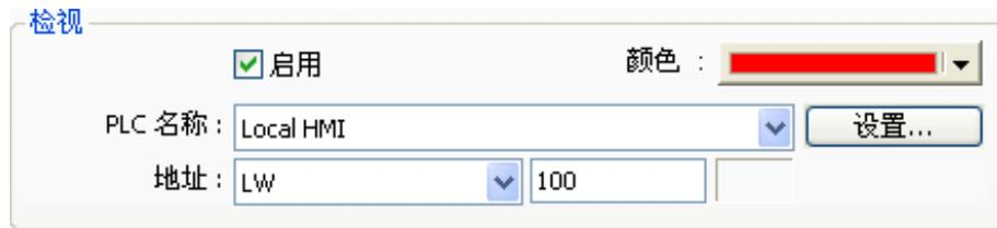
用户除了可以利用图形比较各数据群组外，亦可使用[数据检视]功能，检视各描绘点的数据。开启此功能时，使用者只需触控画面上的输出图形，EB8000将依序将目前所检视的数据编号(Data Index)与各通道的数据依序写入指定的地址中，再通过数值显示(Numeric Display)等元件读出实际内容。所写入各通道数据的资料格式则依照原来各通道定义的资料格式。
