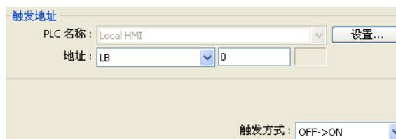
当[触发地址]的状态改变符合触发条件时，“PLC控制”元件将执行指定的宏指令。[触发方式]可以选择：
