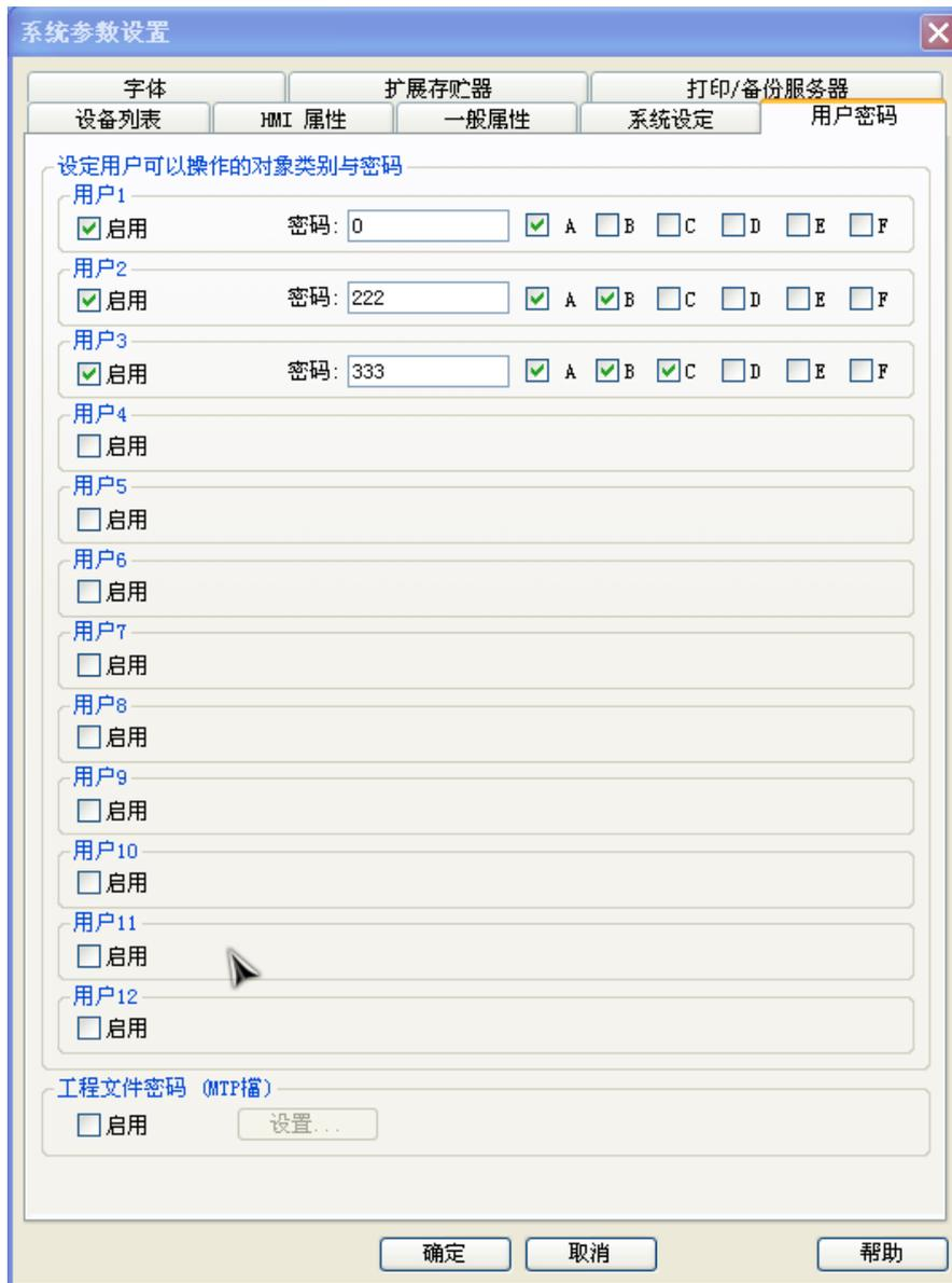
HMI运作时, 用户在成功输入密码后, EB8000会依照用户的设定内容决定用户可以操作的元件类别。在工程文件中, 元件的类别被区分为“无”与“类别A”至“类别F”共7种, 元件可以设定所属的类别, 参考下图。类别属于“无”的元件, 开放给所有用户使用。
