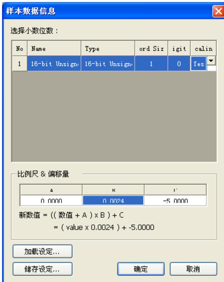
以上的资料设定, 可以储存成样本, 并于下次使用时可以直接载入设定。
