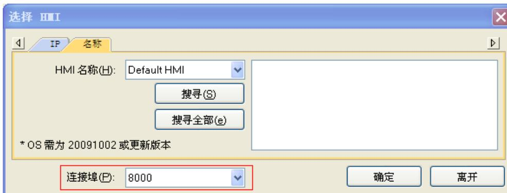
从所设定的端口号算起, 连续三个端口将保留给触摸屏做通讯使用。例如上图中设定的端口号为8000, 则8000、8001、8002三个端口将被保留, 因此在电脑上模拟时, 应确定这些需要保留的端口未被其他程序所占用。
