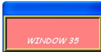
现在使用一个简单的例子说明间接窗口的使用方式, 下图为间接窗口元件的设定内容, 此时使用 [LW100] 用来指定要出现的窗口号码, 并预先建立 “窗口35” 与 “窗口36”。
