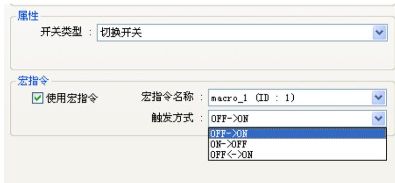
当元件的操作方式, 选择“切换开关”时, 可以设定执行宏指令的条件, 可以选择状态由OFF变为ON或由ON变为OFF时, 才执行宏指令, 也可选择状态改变时 (ON<->OFF), 即执行宏指令。除此之外, 其它操作方式皆在状态改变时, 即执行宏命令。
