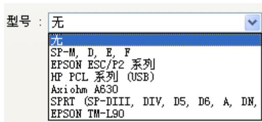
使用COM端口连接的打印机需正确设定COM端口的通讯参数。当打印机的型号为SP-M, D, E, F时，需小心设定 [宽度 (像素)] 此项设定值，此设定值不可以超过打印机每行可以打印的点数，否则将造成错误的打印结果。
