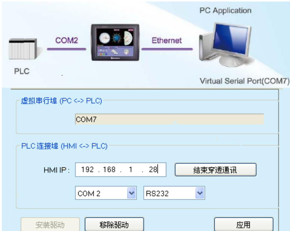
步骤4: 在执行电脑上的应用程序时, 所使用的串行端口需指定使用虚拟串行端口, 以Mitsubishi的应用程序为例, 假如此时的虚拟串行端口为COM 7, 则在[PC side I/F Serial setting]对话框中的[COM port]需选择COM 7, 请参考下图:
