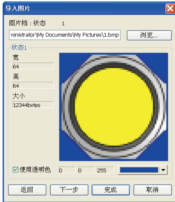
在完成上述的各项动作后，即建立一个完整的图片，可参考下图。这时在图形管理对话框中可以发现新加入的图形“F Yellow”，由图片信息中也可看出此图片为bitmap形式，且包含两个状态。
