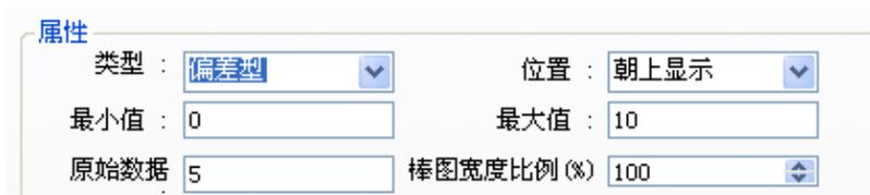
显示方向: 用来选择棒图的显示方向, 可以选择“朝上显示”、“朝下显示”、“朝右显示”、“朝左显示”。
