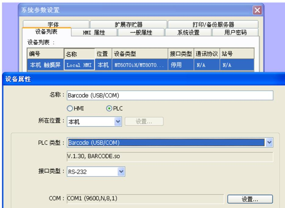
触控上图的“设置”键后,可以设定barcode设备的各项属性,参考下图:
