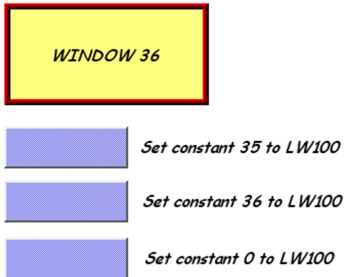
要关闭“窗口35”或“窗口36”除了可以使用“多状态设定”元件SW\_2将[LW100]设定为0之外,另一种方式是在“窗口35”与“窗口36”上设计一个“功能键”元件,并使用[关闭窗口]模式,在触控此元件后即可关闭这些窗口。
