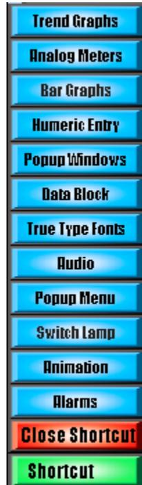
要使用快选窗口除了需先建立3号窗口外, 需再设定“快选窗口按钮” (fast Selection button)的各项功能, 上图的[Shortcut]按钮即是快选窗口按钮, 用来切换快选窗口的出现与消失, 快选窗口按钮的各项设定在系统参数中, 参考下图。
