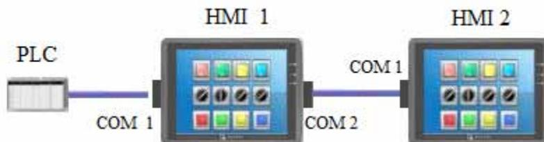
上图显示PLC连接在HMI 1上, HMI 1与HMI 2使用串口直接连接, HMI 2可以透过HMI 1读取PLC上的数据。
