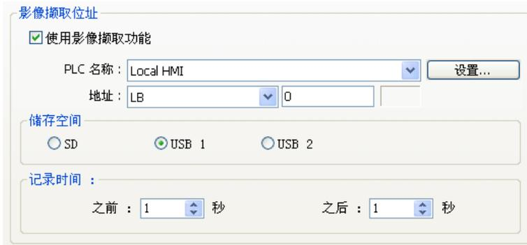
A. 影像撷取地址: 触发系统截取图片的控制地址
