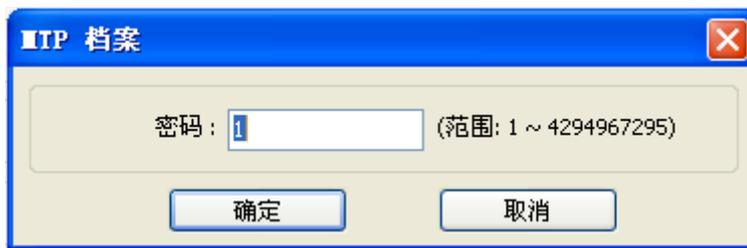
完成设定后,再打开该工程文件时,会弹出下面的对话框,要求用户输入密码才能进入工程文件。
