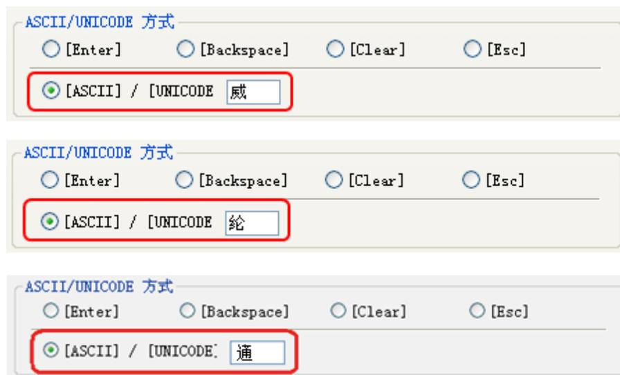
经过上面的步骤, 制作了“威纶通”这三个文字输入功能键, 再制作一个ENTER输入功能键, 即做好了一个简单的文字键盘。再放置一个“字元输入”元件在窗口画面上, 字数选择为6(一个文字为2个字元), 并勾选“使用UNICODE”, 最后做好的画面如下所示:
