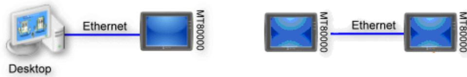
所谓“远端HMI”是指非本地HMI的所有其它HMI, PC也被视为远端HMI的一种, 此时要控制远端HMI需先增加此种类型的设备。在触控[新增...]按键后, 只需在设定对话框中正确设定各项属性即可。
