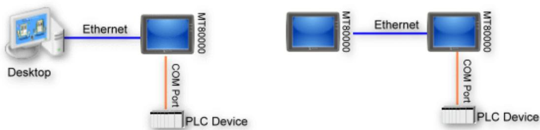
所谓“远端PLC”是指直接连接在远端HMI的PLC,此时要控制远端PLC需先增加此种类型的设备。在触控[新增...]按键后,只需在设定对话框中正确设定各项属性即可。
