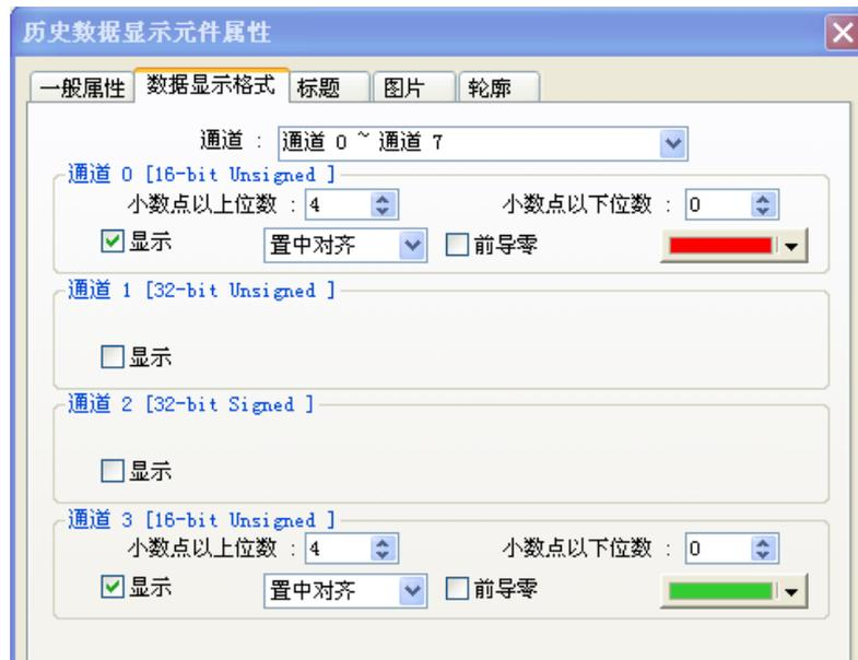
上图的对话框用来设定资料取样的显示格式，由上图可以发现目前使用的“资料取样”元件执行一次取样的动作将读取4个数据(通道0~通道3)，由上图也可以发现各数据的数据格式(例如通道0为16-bit Unsigned)，这些皆定义在“资料取样”元件中。由上图可以看出目前设定只显示通道0与通道3的数据，参考下图。
