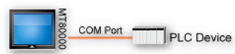
所谓“本机PLC”是指直接连接在本地触摸屏上的PLC，此时要控制本机PLC需先增加此种类型的设备。在触控[新增...]按键后，只需在设定对话框中正确设定各项属性即可。
