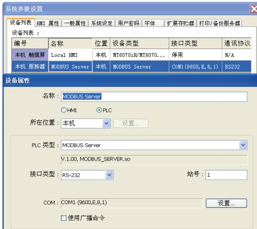
当接口选择使用RS232或RS485时, 需选择使用的连接端口(COM 1 ~ COM 3), 并设定正确的通讯参数, 参考下图, 此时MODBUS Server的站号设定为1。
